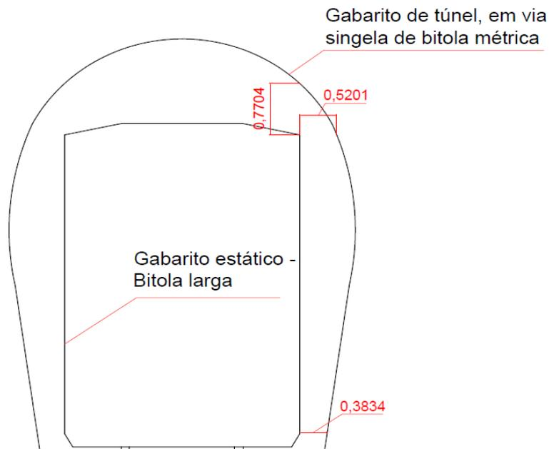
Figura 7 – Inserção do gabarito estático de bitola larga no gabarito de túnel de bitola métrica, com dimensões em metros
